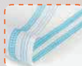
triple point de recouvrement (6 mm) 3 aiguilles - 4 fils
