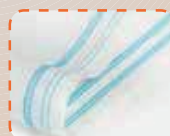
point de recouvrement étroit (3 mm) 2 aiguilles - 3 fils étroit gauche ou étroit droit
